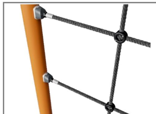
Die Seile bestehen aus UV-stabilisiertem PES mit innerer Stahlseilverstärkung. Das Seil ist induktionsbehandelt, um eine starke Verbindung zwischen Stahl und Seil zu schaffen, die zu einer guten Verschleißfestigkeit führt.
