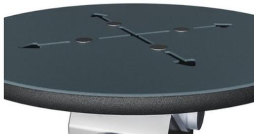
La piastra superiore da 414 mm è realizzata in Ekogrip da 15 mm, una piastra polietilene (PE) da 15 mm con uno strato superiore in gomma termoplastica da 3 mm con effetto antiscivolo. L'altezza è di 217 mm e la gamma di movimento è di +/- 90, con uno strato in gomma EPDM su ciascuna estremità.
