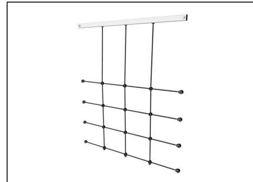
Kletternetze werden aus UV-stabilisiertem PP-Seil mit innerer Stahlseilverstärkung hergestellt. Das Seil ist induktionsbehandelt, um eine maximale Fixierung zwischen Stahl und Seil zu erreichen, was eine ausgezeichnete Verschleiss- und Reißfestigkeit bietet. Alle Seilverbinder sind aus 100% recyclebarem PA-Material hergestellt.
