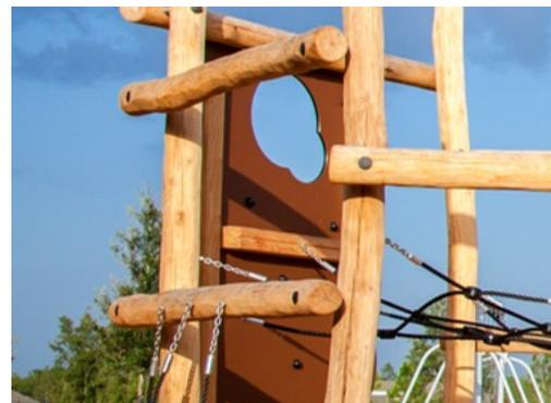
Panel de escalada de contrachapado. Los paneles de escalada están hechos de madera contrachapada de 21,5 mm de espesor hecha de aliso y madera de pino. Ambos lados están cubiertos por 2 capas de película fenólica con patrón de red antideslizante. Todos los bordes de corte están sellados con pintura para garantizar una larga vida útil.
