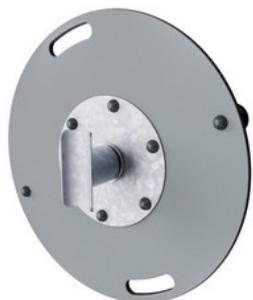
La sede del cuscinetto è in acciaio zincato a caldo. L'albero del cuscinetto è realizzato in acciaio inossidabile AISI304. Il cuscinetto stesso è realizzato in polioossimetilene (POM), un tecnopolimero termoplastico con elevata rigidità, basso attrito ed eccellente stabilità dimensionale.
