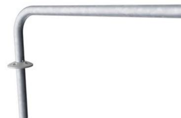
El pasamanos diseñado como agarre durante los ejercicios está hecho de acero galvanizado en caliente de 38 mm, un gran diámetro para un buen agarre y para apoyar la muñeca. La altura del pasamanos es de 940 mm desde la parte superior de la placa HPL. La distancia entre los rieles es de 900 mm.
