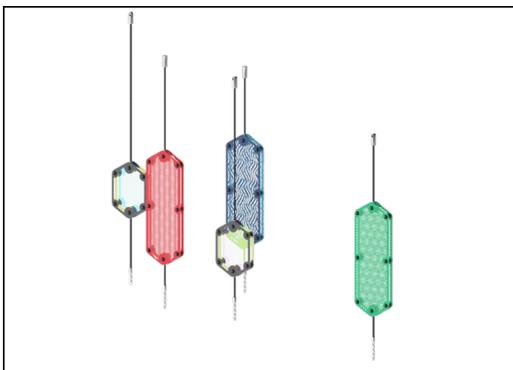
Pannelli ottici girevoli di due lastre in policarbonato spessore 7mm con una distanza di 40mm. La stampa grafica interna è costituita da uno strato di immagine esterno e uno strato di protezione trasparente esterno. Sia il pannello PC che la vernice a base d'acqua sono stabilizzati ai raggi UV per prevenire lo sbiadimento della stampa.
