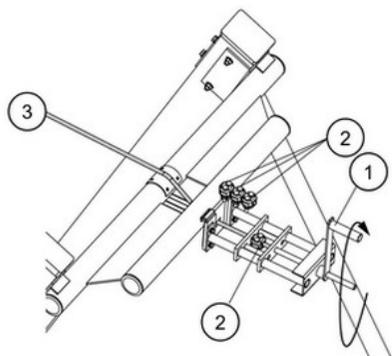
Il cavo d'acciaio (3) è messo in tensione da un dispositivo appositamente progettato. Ruotando la maniglia (1) il cavo d'acciaio può essere teso secondo le istruzioni in modo sicuro. Dopo aver messo in tensione il cavo è bloccato da tre morsetti (2). Il dispositivo di tensionamento può essere utilizzato anche per la regolazione durante le ispezioni annuali.
