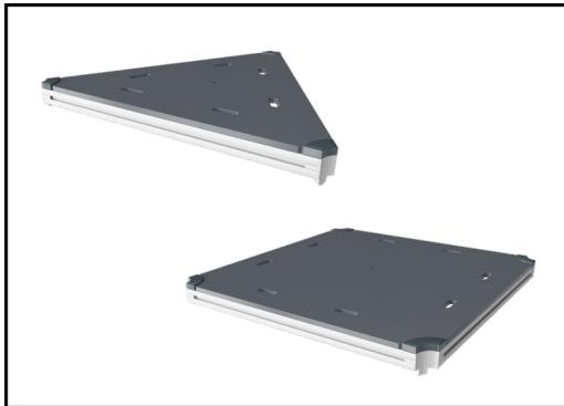
Všechny plošiny jsou podepřeny jedinečně navrženými hliníkovými profily s více možnostmi připojení pomocí lisovaných hliníkových konektorů. Plošiny jsou vyrobeny z HPL o tloušťce 17,8 mm s velmi vysokou odolností proti opotřebení a jedinečnou povrchovou texturou KOMPAN.
