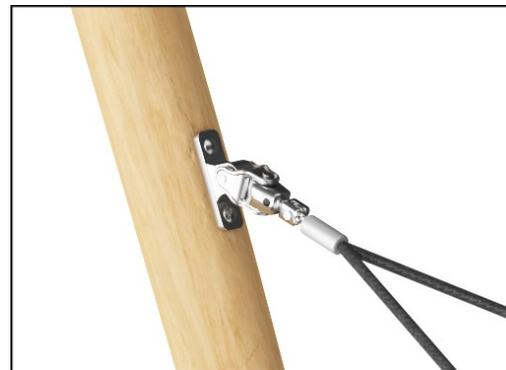
I ganci oscillanti sono realizzati con staffe in acciaio inossidabile e possono spostarsi su due assi. I cuscinetti a flangia sono arricchiti in silicone per rendere la sospensione esente da manutenzione. Al fissaggio della fune è presente una funzione anti torsione girevole che impedisce l'avvolgimento delle corde.
