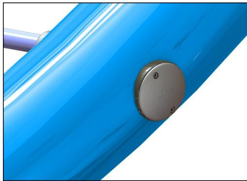
Lano je připevněno k velké ocelové trubce unikátním řešením utahování KOMPAN. Skládá se z vnitřních a vnějších nylonových (PA6) průchodek, které vedou lano k vnější závitové hliníkové části, která lano napíná.
