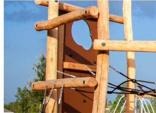
Panneau d'escalade en contreplaqué. Les panneaux d'escalade sont fabriqués en contreplaqué de 21,5 mm d'épaisseur en bois d'aulne et de pin. Les deux côtés sont revêtus de 2 couches de film phénolique avec texture en maillage anti-dérapante. Tous les bords de coupe sont encapsulés avec de la peinture afin d'assurer une longue durée de vie.
