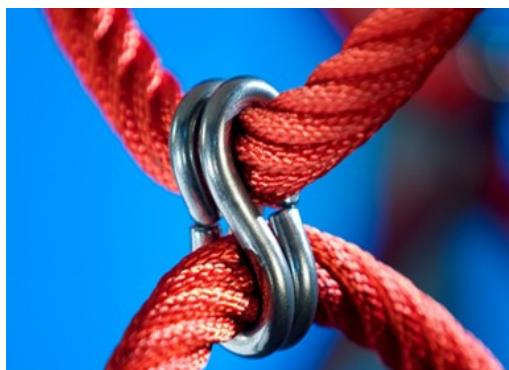
„S“ svorky Corocord se u produktů Corocord používají jako univerzální spojovací prvek. 8mm nerezové dráty se zaoblenými konci jsou za pomoci speciálního hydraulického nástroje nalisovány kolem lana, což z nich dělá ideální konektor: bezpečný a odolný proti vandalismu s dlouhou životností, to vše s umožněním typického pohybu lanových herních struktur.
