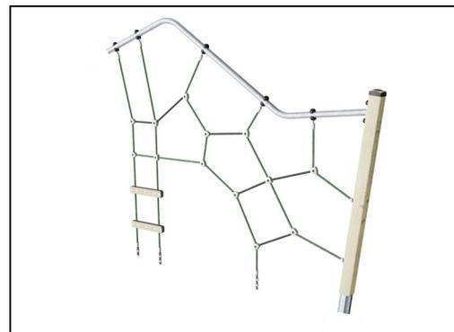
Les filets de corde sont constitués de cordes PES simples tressées de 16 mm. Le PES a une résistance élevée avec une excellente résistance à l'abrasion et aux rayons UV. Les boucles de corde sont assemblées par des connecteurs en aluminium.
