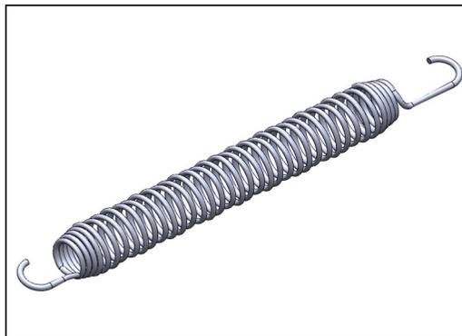
Les 36 ressorts sont en acier inoxydable pour assurer une durabilité et une excellente résistance à la corrosion. Le fil d'acier a une épaisseur de 3,2 mm et les cinq derniers enroulements sont en forme de cône pour assurer une longue durée de vie du trampoline.
