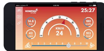
È possibile collegare la macchina cardio al telefono o tablet tramite Bluetooth. Ciò fornirà un feedback immediato su velocità, distanza, battito, watt, calorie bruciate e tempo. Puoi anche utilizzare i tuoi dispositivi per regolare manualmente la resistenza (10 livelli), avere accesso a video istruttivi e motivazionali, archiviare e condividere dati di attività online!
