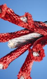
直径大于等于 19mm 的 Corocord 绳索是特殊的“大力神”型镀锌六股钢丝。每根丝束都用 PES 纱紧密包裹，然后将其熔化到每根独立的丝束上。这些绳索具有很高的耐磨性和防破坏性，可以根据需要在现场更换。
