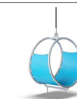
游戏舱设计为两个钢环的焊接框架，这些钢环经过热浸镀锌和粉末涂层处理。软膜由输送带质量的抗磨橡胶材料制成，具有出色的抗紫外线性。
