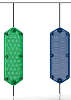
两块 7mm 厚的聚碳酸酯材质变色面板，间距为 25mm。内部图形打印由内部图像层和外部透明保护层组成。PC 面板和水性漆均经过紫外线稳定处理，以防止印刷元素褪色。
