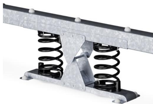
Pružiny KOMPAN jsou vyrobeny z vysoce kvalitní pružné oceli podle EN10270. Pružiny jsou očištěny fosfátováním předtím, než jsou natřeny epoxidovým základním nátěrem a polyesterovým práškovým povlakem pro konečnou úpravu. Pružiny jsou připevněny jedinečnými pojistkami proti přeskřípnutí pro maximální bezpečnost a dlouhou životnost.
