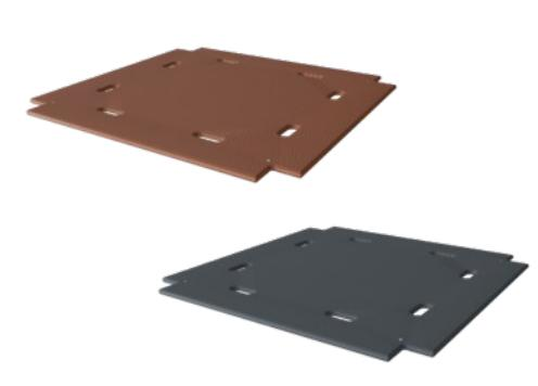
地板和面板有两种类型的材料：厚度为 21.5mm 的防水胶合板，由松木和赤杨木制成，两侧均带有防滑膜。高压层压板 HPL 厚度 17.8mm，根据 EN 438-6 具有防滑表面纹理。
