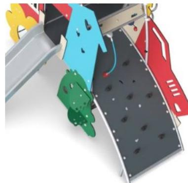
Le mur d'escalade incurvé est fabriqué à partir d'un panneau Ekogrip® qui se compose d'une base de PE de 15 mm d'épaisseur avec une couche de 3 mm de caoutchouc souple pour un effet antidérapant.
