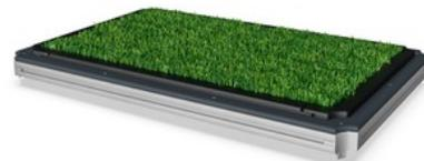
Die Grasfläche ist 1210x710mm groß. Das Gras ist getuftet, ungefüllter Kunstrasen, der mit Polyurethankleber (Henko H400 oder H700) auf die HPL-Platte geklebt wird. Die HPL-Platte hat Abflusslöcher, um das Wasser schnell abzuleiten.
