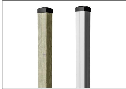
主塔柱有两种类型的材料：欧洲松木柱，根据 EN335 标准，木材用 Tanalith E3475 标准进行 3 级压力浸渍（相当于 NTR AB 级）。铝柱  $t = 2\text{mm}$ ，经阳极氧化表面处理。基础材料 EN AW-6060 T66。
