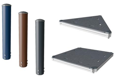
立柱由优质预镀锌钢制成，表面覆盖粉末涂层。柱顶由防紫外线的尼龙 (PA6) 盖封闭。灰色模压平台底板由 75% 海洋渔业消费后可循环 PP 材料制成，表面有防滑图案和纹理。所有平台底板均由独特设计的低碳铝型材支撑，可安装多种不同游戏板功能配件。
