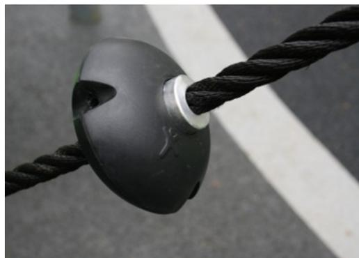
Les cordes GALAXY sont fabriquées de 6 torons d'acier et d'une âme métallique en acier. Chaque toron est enveloppé hermétiquement dans du fil en PES. Une fois que le frottement initial a usé les fibres de surface, un revêtement plus dur de PES reste pour protéger chaque brin, garantissant une excellente résistance à l'usure et au vandalisme.
