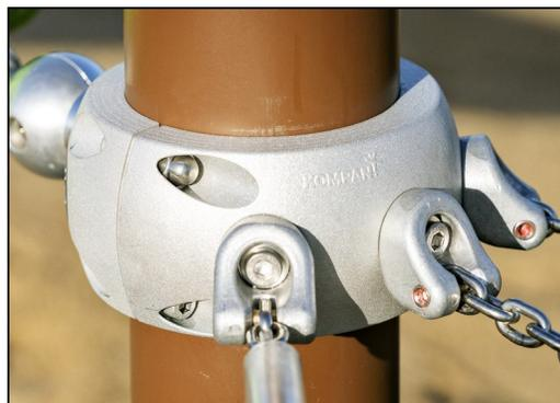
I morsetti intelligenti Corocord sono attentamente progettati in materiale di alluminio di alta qualità per garantire un'elevata flessibilità. I morsetti intelligenti vengono fissati attorno ai montanti con quattro bulloni in acciaio. I punti di fissaggio non utilizzati vengono chiusi con coperture in poliammide (PA).
