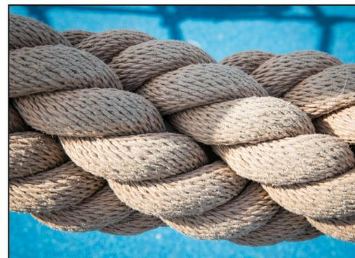
La corda in PP in stile cocco ha un diametro di 150 mm. L'anima interna in filo di acciaio presenta ditali ad entrambe le estremità, che fungono da attacchi per la fune agli elementi di collegamento esistenti.
