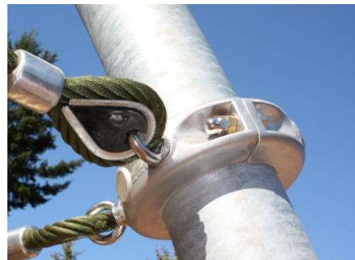
Les étriers en aluminium Corocord sont utilisés comme connecteurs entre les poteaux en acier et les câbles. Deux pièces en aluminium moulées sont fixées l'une à l'autre. La hauteur des attaches est donc variable.
