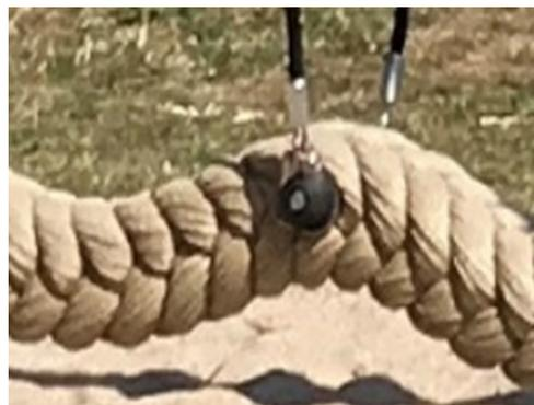
La chaîne/cordes sont attachées à la corde coco par des bagues pivotantes KOMPAN en acier inoxydable avec des douilles en bronze. Les pivots possèdent un enrobage extérieur en PUR noir. Grâce aux pivots latéraux, le mouvement s'effectue sans friction, il n'est pas possible de se coincer les doigts ou les pieds, et la surface debout au-dessus de la corde est plus importante.
