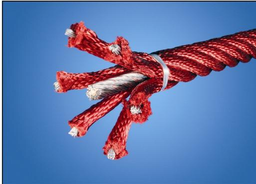
Corocord-Seile werden speziell mit der Hercules-Technik gefertigt. Sie bestehen aus verzinkten, sechslitzigen Stahldrahtseilen und sind mit einer Stahldrahtseele versehen. Jede Litze ist mit PES-Garn umwickelt, das induktiv aufgeschmolzen wird. Die Seile sind äußerst beständig gegenüber Abnutzung und gut vor Vandalismus geschützt. Sie können jederzeit ausgetauscht werden.
