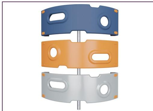
Gli elementi rampicanti visualizzati sono stampati in un unico pezzo con uno spessore minimo di 5 mm. Gli elementi da arrampicata sono realizzati in PE riciclabile che ha un'elevata resistenza agli urti su un'ampia fascia di temperatura che garantisce resistenza agli atti vandalici in tutti i luoghi.
