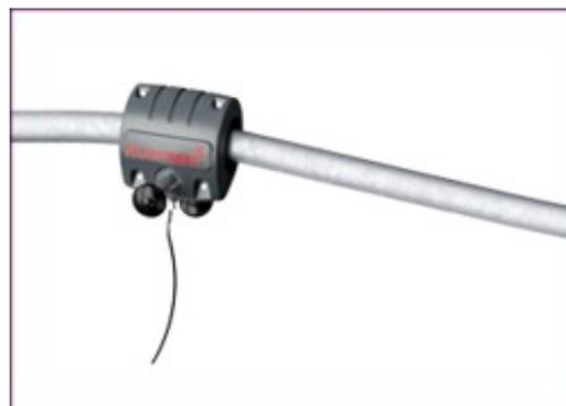
Подвесная тянушка спроектирована с приваренным стальным сердечником и покрыта полиэтиленовым корпусом низкой плотности. Две горячепогруженные оцинкованные стальные ручки расположены под углом, чтобы обеспечить наилучшую эргономичность при скольжении. Колеса тянушки изготовлены из малошумного ТПУ и установлены с герметичными шарикоподшипниками.
